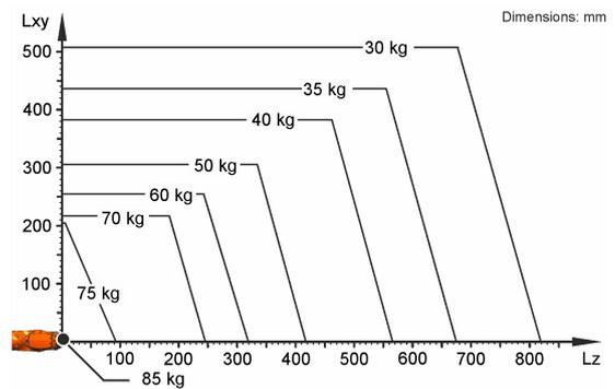
Der KR 70 R2100 ist ausgelegt für eine Nenn-Traglast von 70 kg, um die Performance und Dynamik des Roboters optimal zu nutzen. Mit reduzierten Lastabständen und günstigen Zusatzlasten, kann eine maximale Traglast bis zu 85 kg angebracht werden. Der spezifische Lastfall muss mit KUKA Load überprüft werden. Für weitere Beratung steht der KUKA Service zur Verfügung.
